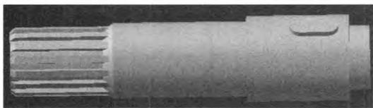
图 1 齿轮轴实体模型
