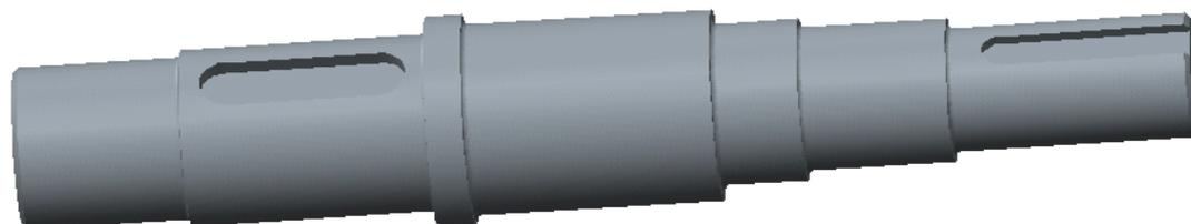
图 2.5.13 旋转生成轴、拉伸键槽
