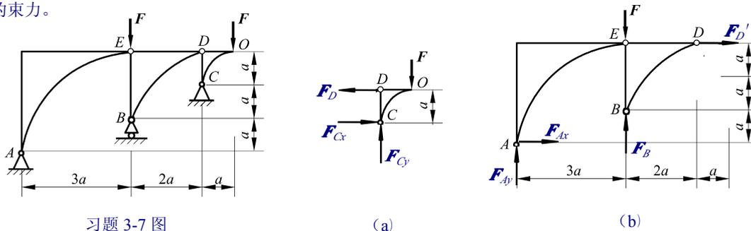
**解：**先分析半拱  $BED$ ， $B$ 、 $E$ 、 $D$  三处的约束力应汇交于点  $E$ ，所以铰  $D$  处的约束力为水平方向，取  $CDO$  为研究对象，受力如图 (a) 所示。
