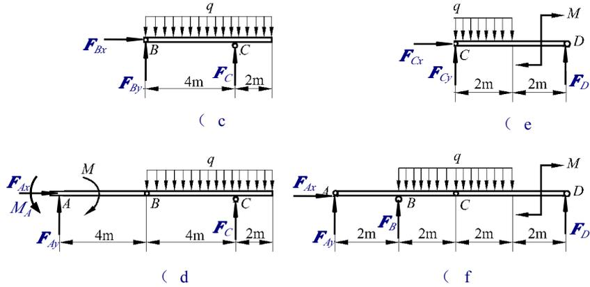
(1) 取图 (a) 中多跨梁的  $BC$  段为研究对象, 受力如图 (c) 所示。
