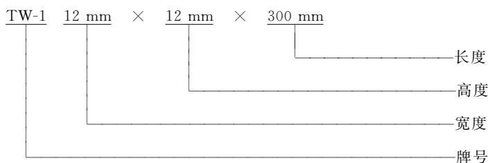
示例 2：长 300 mm、直径 12 mm 的 TW-1 圆条表示方法为：
