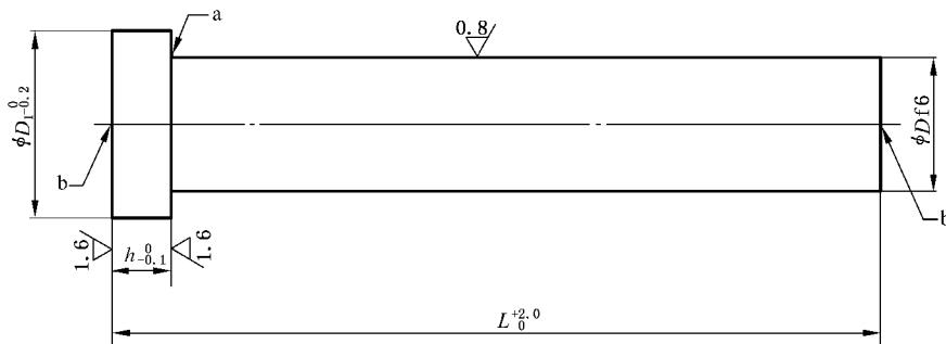
未注表面粗糙度  $R_a=6.3 \mu\text{m}$ 。
