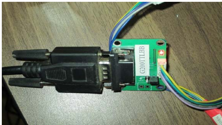
图 5-5 短信模块自带的转接板 G200TTLBB
