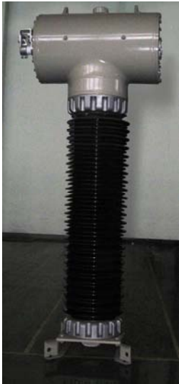
图 6.1 110kV SF 6 同轴圆筒型电容传感头样机
