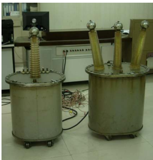
图 6.19 电流型 EVT 校准试验平台设备图
