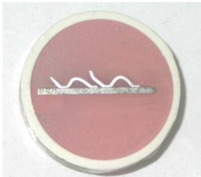
图 3-8 牙托粉镶样抛光后的 SEM 观测样品
