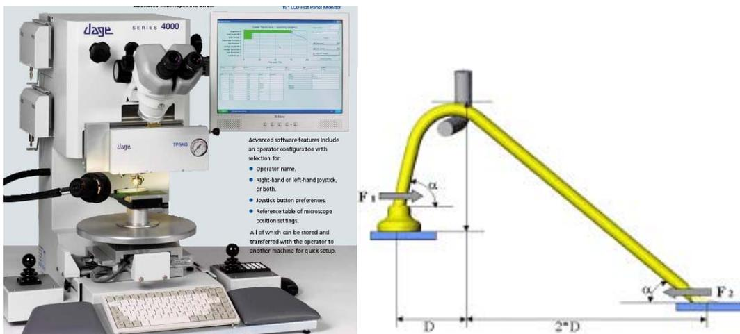
图 3-5 拉力计分离球键合界面
