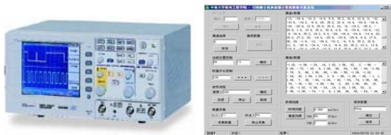
图 3-37 基于示波器与 PC 机通讯的数据采集系统
