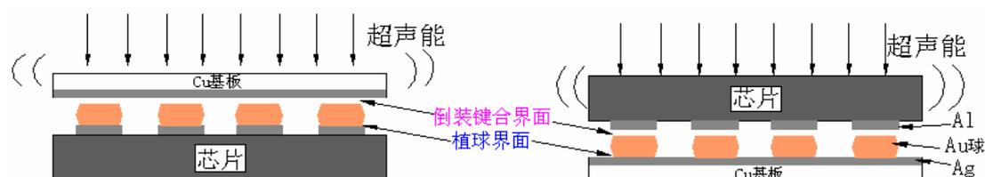
图 5-17 “基板传能”模式(左)和“基板植球”模式(右)的热声倒装
