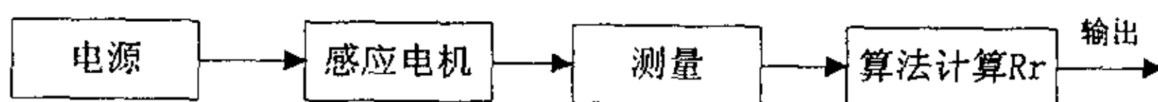
图 5.1 感应电机参数辨识仿真结构框图
