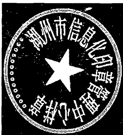
图 2-6 基于 LOG 算子的局部动态阈值算法的二值化效果
