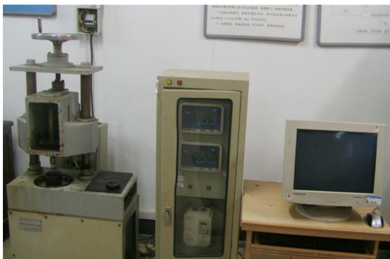
图 4.1 XP-1 型销盘摩擦磨损实验机
