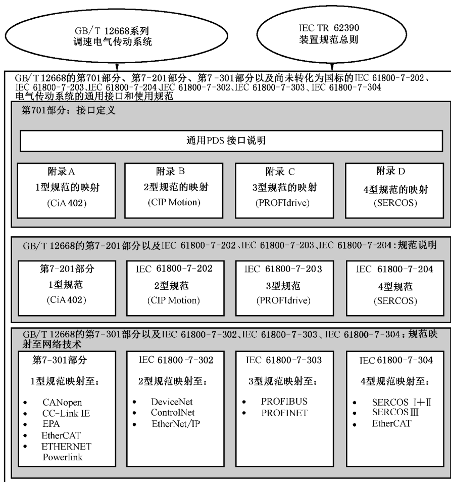
图 1 GB/T 12668 的第 701 部分、第 7-201 部分、第 7-301 部分以及尚未转化为国标的 IEC 61800-7-202、IEC 61800-7-203、IEC 61800-7-204、IEC 61800-7-302、IEC 61800-7-303、IEC 61800-7-304 的结构
