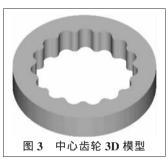
ENGINEER 的高级语言 Program 模块进行程序化 编程设计,控制中心齿轮 的几何造型,设计出系列 中心齿轮。由于篇幅所限, 这里仅给出连杆长80 mm、 偏心距3 mm、传动比14、 齿数15 的中心齿轮3D 模型,见图3所示。
