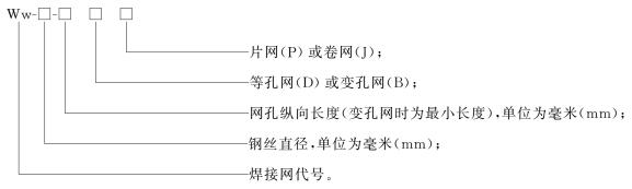
示例:钢丝直径 4 mm, 网孔长 150 mm 的等孔片网代号为: Ww-4. 0-150DP。
