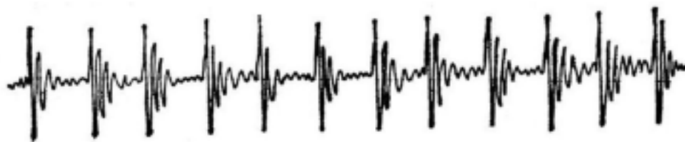
图 3.1 齿轮磨损后引起的振动(高频)
