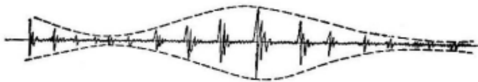
图 3.4 有偏心、周节误差的齿轮发生的振动(高频)
