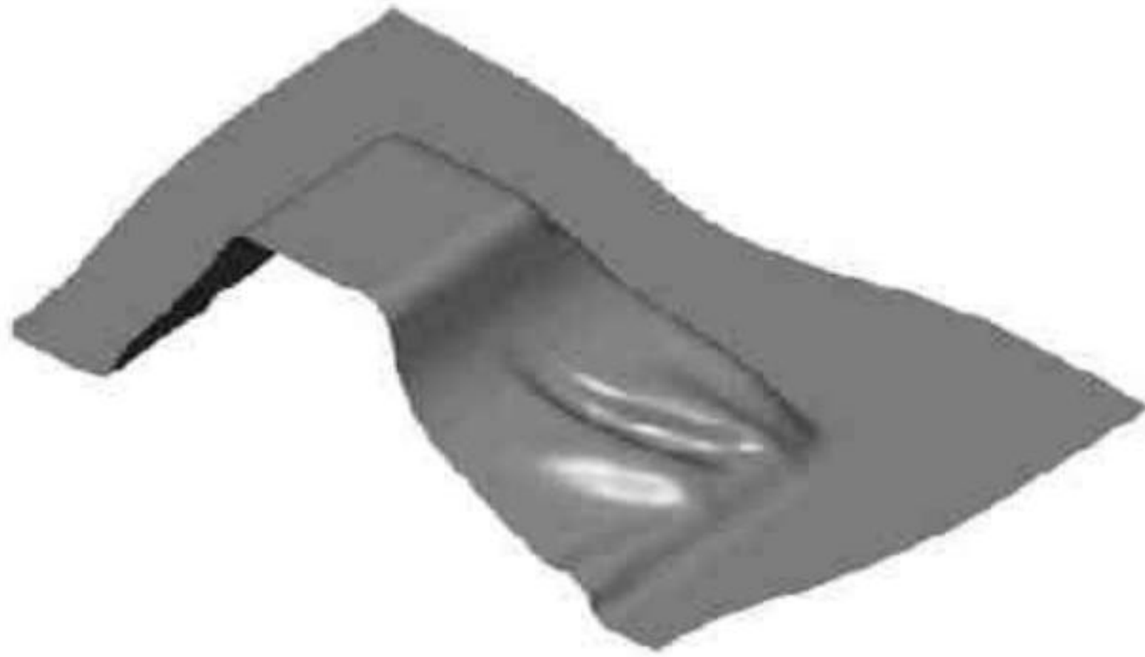
图 10 当板料接触台阶边缘的起皱形成
