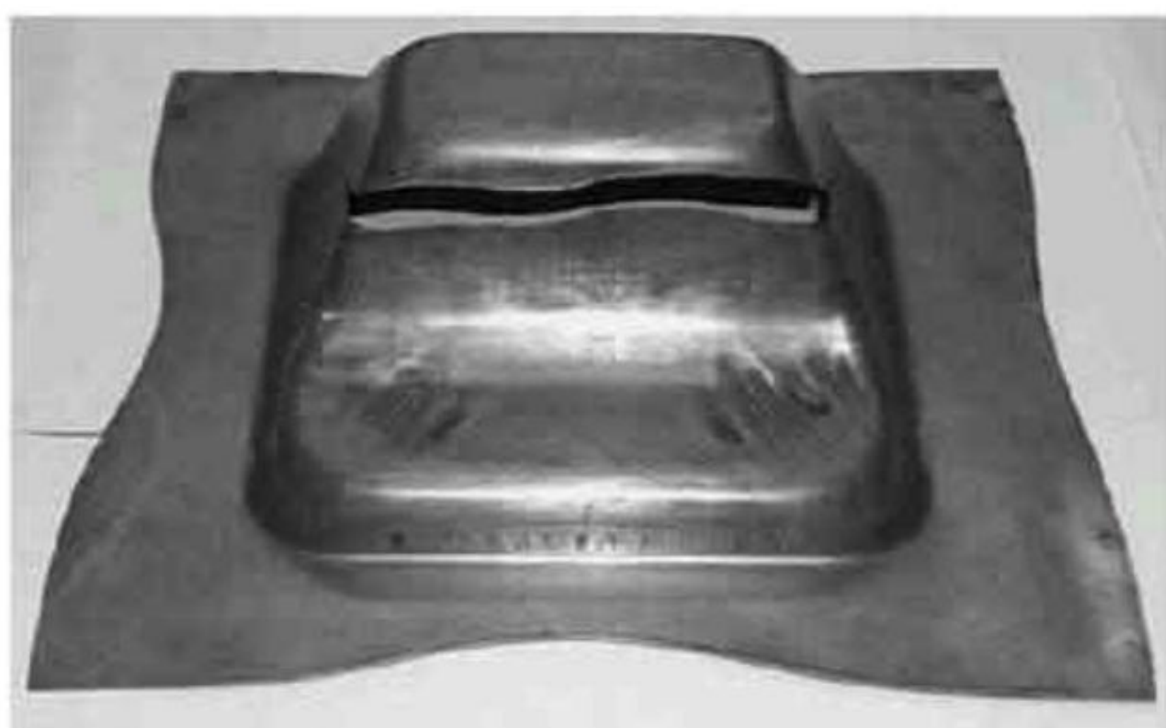
图 7 产品零件中的拉裂和起皱
