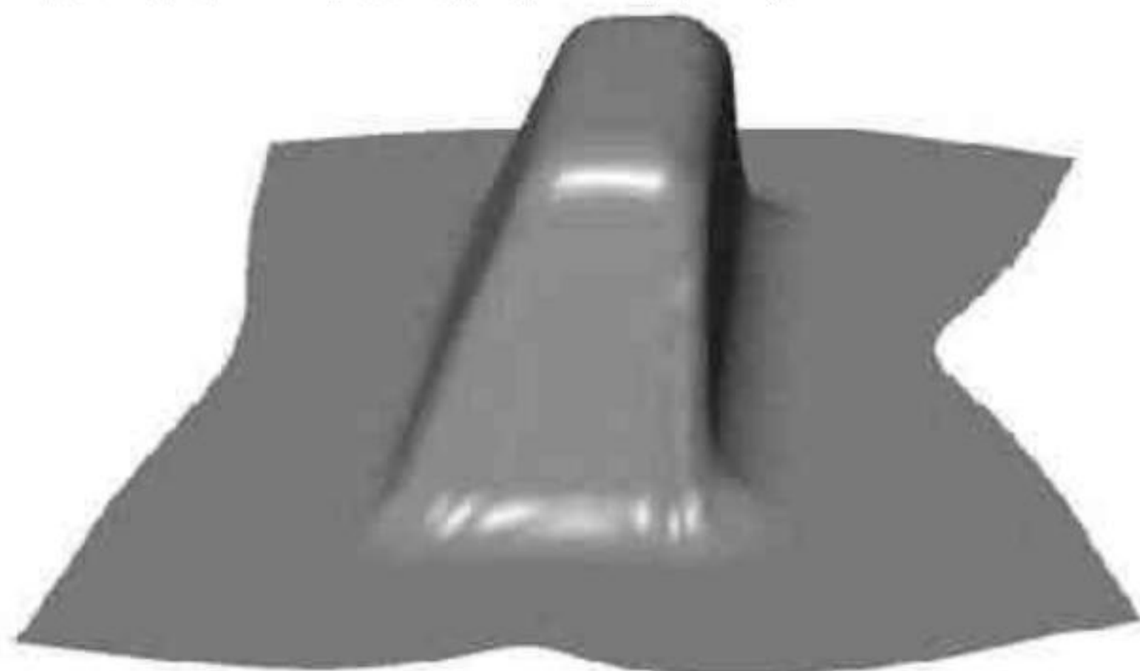
图 12 改善模具设计的模拟形状
