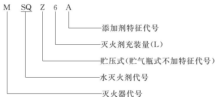
标记示例:手提贮压式 6 升添加防冻剂的水型灭火器表示为 MSQZ6A,手提贮压式 6 升清水灭火器表示为 MSQZ6。
