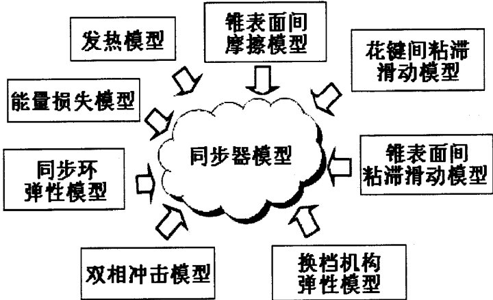
图 3.2 同步器模型的组成 Fig. 3.2 Composition model of the synchronizer
