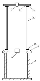
C---- 无色透明圆筒,高 430 mm,内径 200 mm;
