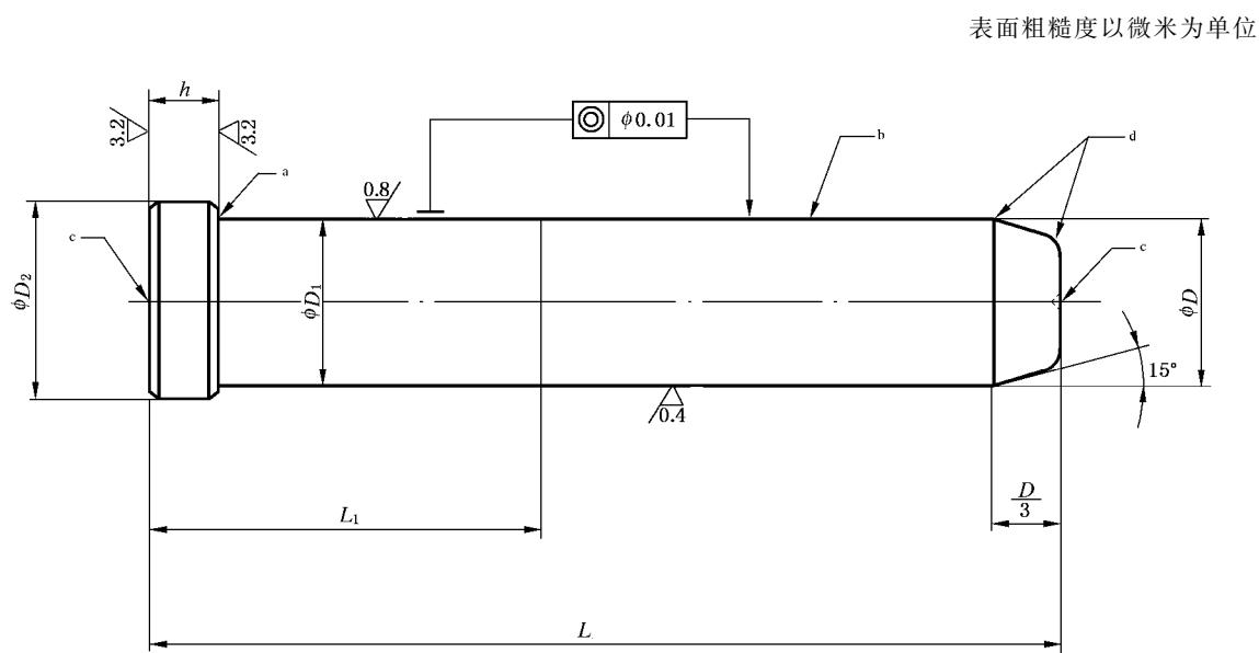
未注表面粗糙度  $R_a=6.3 \mu\text{m}$ ；未注倒角  $1 \text{ mm} \times 45^\circ$ 。
