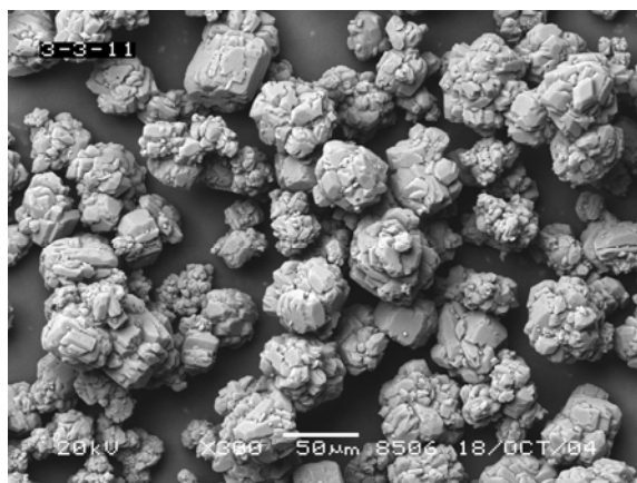
图 3-16 附聚 9 小时的 SEM 照片(放大 300 倍)
