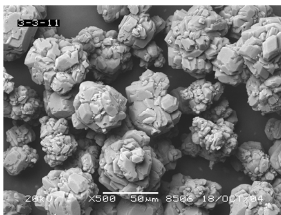
图 3-17 附聚 9 小时的 SEM 照片(放大 500 倍)
