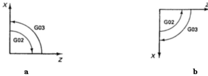
图1 圆弧的顺逆方向与刀架位置的关系
