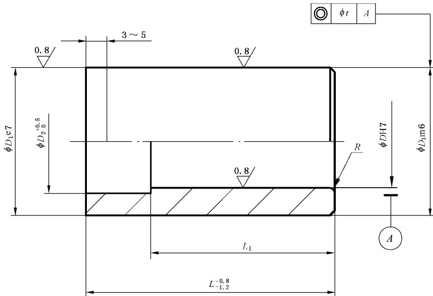
未注表面粗糙度  $R_a=3.2 \mu\text{m}$ ；未注倒角  $1 \text{ mm} \times 45^\circ$ 。
