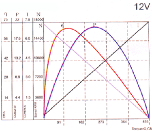
电机效率、功率、转距特性，固有机械特性曲线
