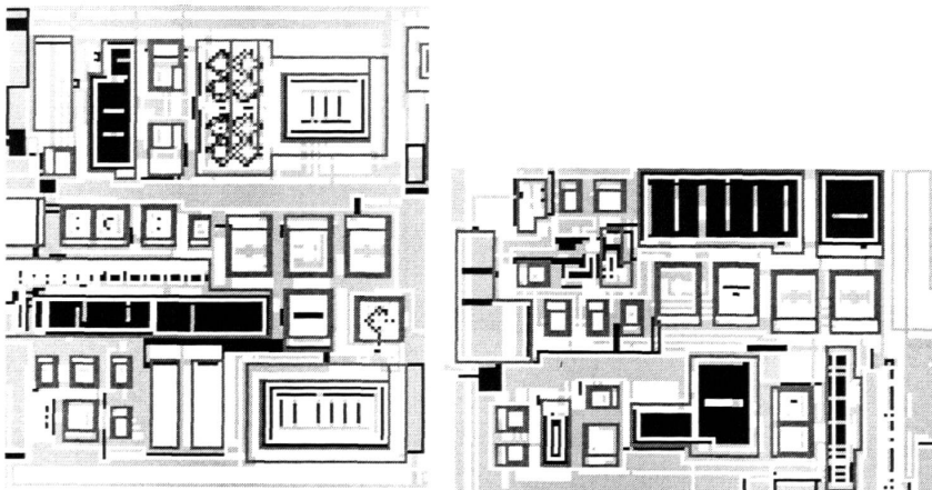
图 4.2.3 电压调整器和带隙基准源版图
