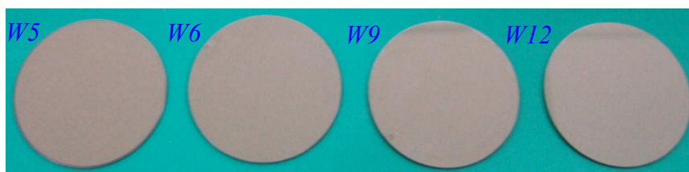
Fig.5-2 化學機械拋光後試片圖
