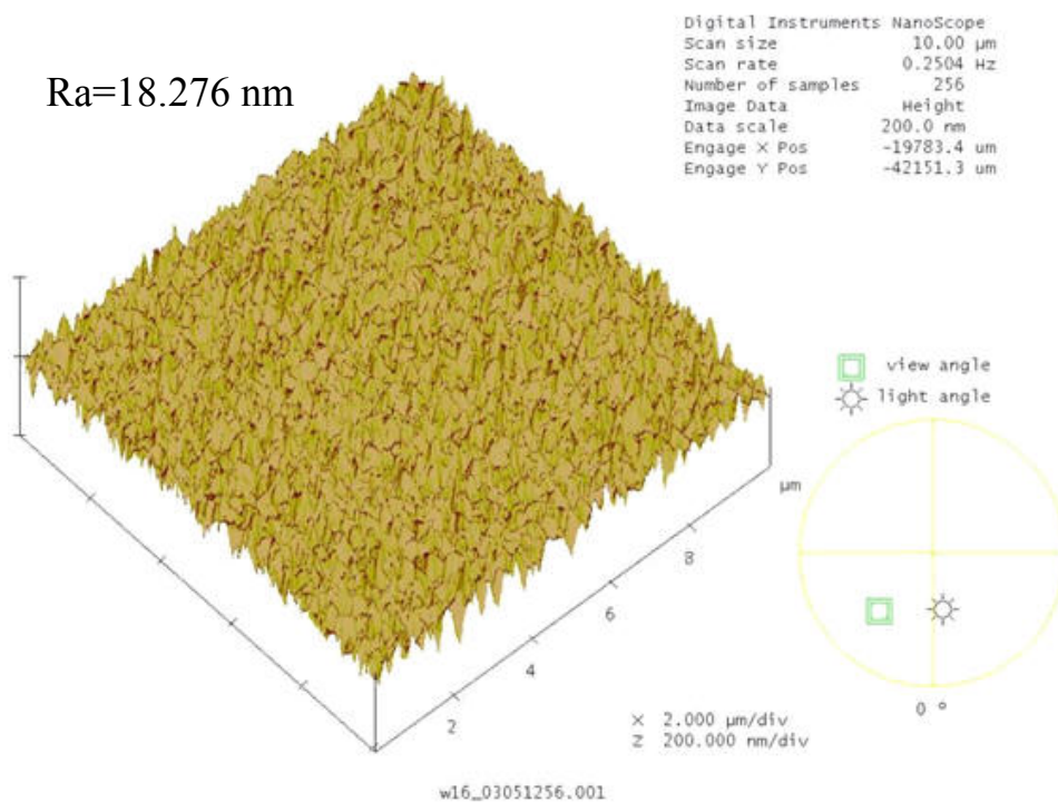
Fig.5-3 CVD 薄膜試片粗糙度
