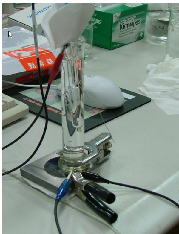
Fig.4-7 電化學拋光電極的接法
