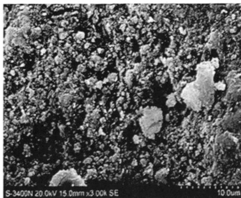
图 6.12 水泥赤泥稳定级配碎石的低倍扫描电镜图
