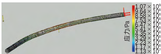
图 8 横向稳定杆在最大力作用下的 Von Mises 应力分布图
