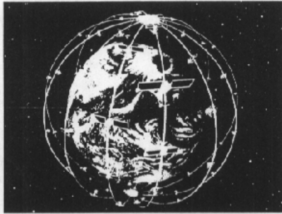
图 1-1 典型的卫星移动通信系统星座示意图
