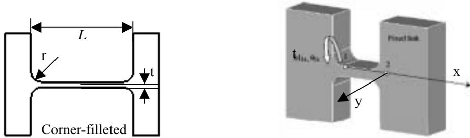
图 2.3 圆角簧片的结构示意图
