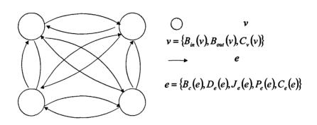
图 2.3 覆盖组播网络模型示意图
