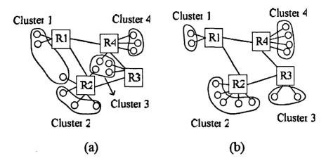
图 4.1 在最低层划分 cluster 时 NICE 与 HFTM 的区别: (a) NICE; (b) HFTM 另外, HFTM 在构造组播树的时候考虑了不同 local area 所包含的组播组成员数, 这样做的目的是为了避免由于组播组成员在 local area 内分布极度不均匀而获得一棵极度不均衡的组播树。HFTM 协议通过对 local area 尺寸的考虑,可以获得一棵均衡的组播树。
