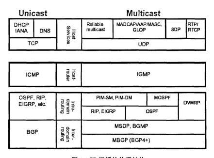
图 1.1 IP 组播的体系结构
