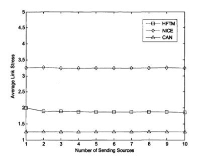
图 4.7 源数目在 1 到 10 范围内三种协议的 ALS 性能比较
