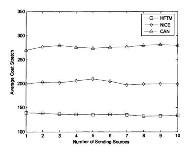
图 4.8 源数目在 1 到 10 范围内三种协议的 ACS 性能比较
