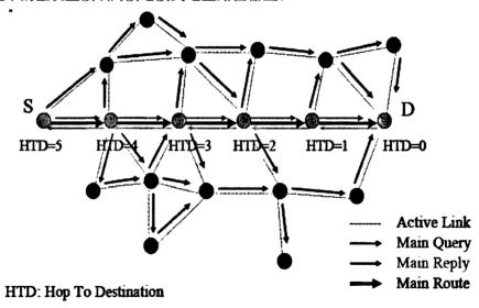
图 4.2 模拟实验中所用的骨干网结构
