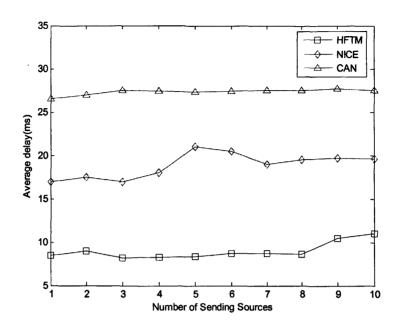
图 4.6 源数目在 1 到 10 范围内三种协议的 AED 性能比较
