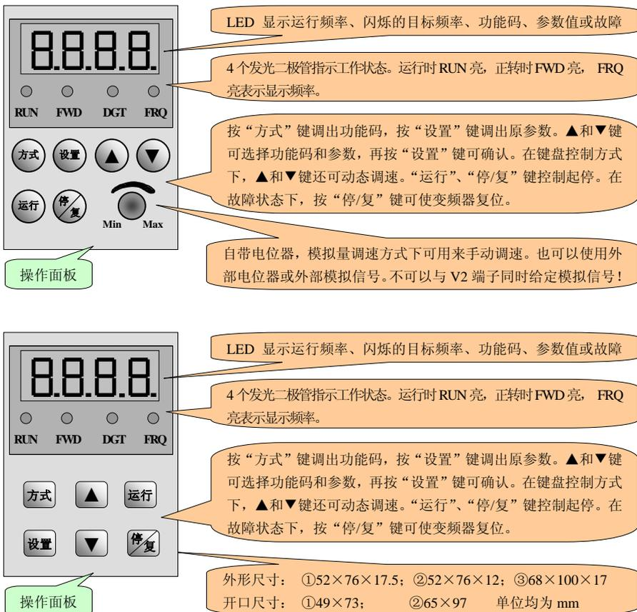
图 2-1 两种形式的操作面板
