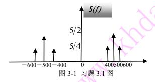
**习题 3.2** 在上题中,已调信号的载波分量和各边带分量的振幅分别等于多少? 解:由上题知,已调信号的载波分量的振幅为 5/2,上、下边带的振幅均为 5/4。
