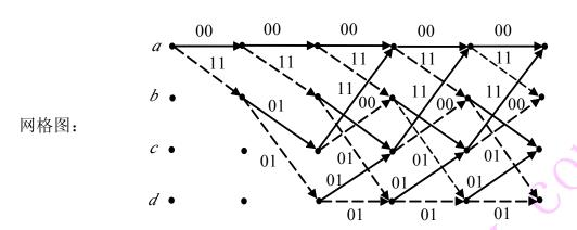
**习题 10.17** 已知一个 (2, 1, 2) 卷积码编码器输出和输入的关系为  $c_1 = b_1 \oplus b_2$ ,  $c_2 = b_3 \oplus b_3$
