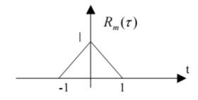
可以对 $R_{m}(\tau)$ 求两次导数,再利用付氏变换的性质求出 $R_{m}(\tau)$ 的付氏变换。
