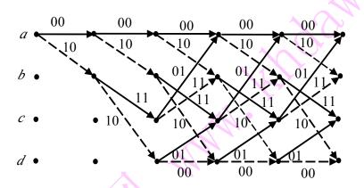
**习题 10.18** 已知一个 (3, 1, 4) 卷积码编码器的输出和输入关系为  $c_1 = b_1$ ,  $c_2 = b_1 \oplus b_2 \oplus b_3 \oplus b_4$ ,  $c_3 = b_1 \oplus b_3 \oplus b_4$
