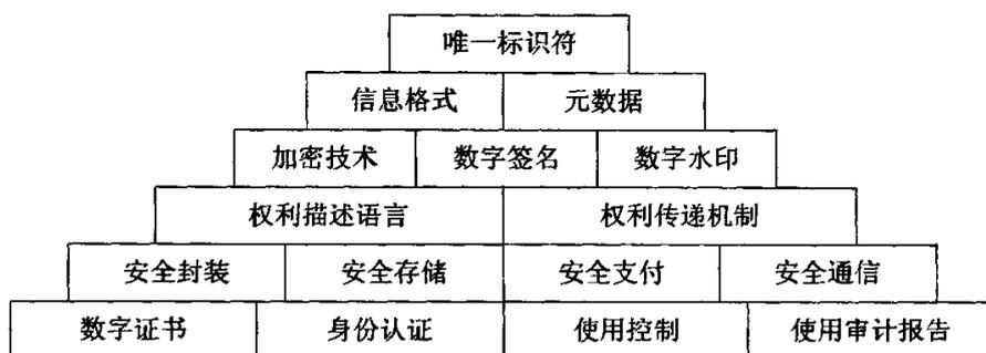
图 2-1 DRM 技术体系的基本构成
