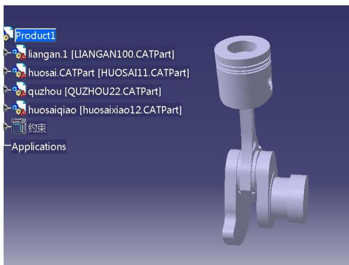
图 3.6 曲轴连杆装配后的几何模型
