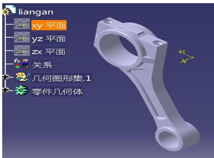
图 3.4 连杆的几何模型
