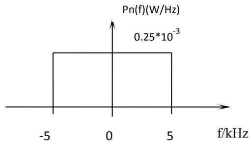
图 3-4 解调器输出端的噪声功率谱密度
