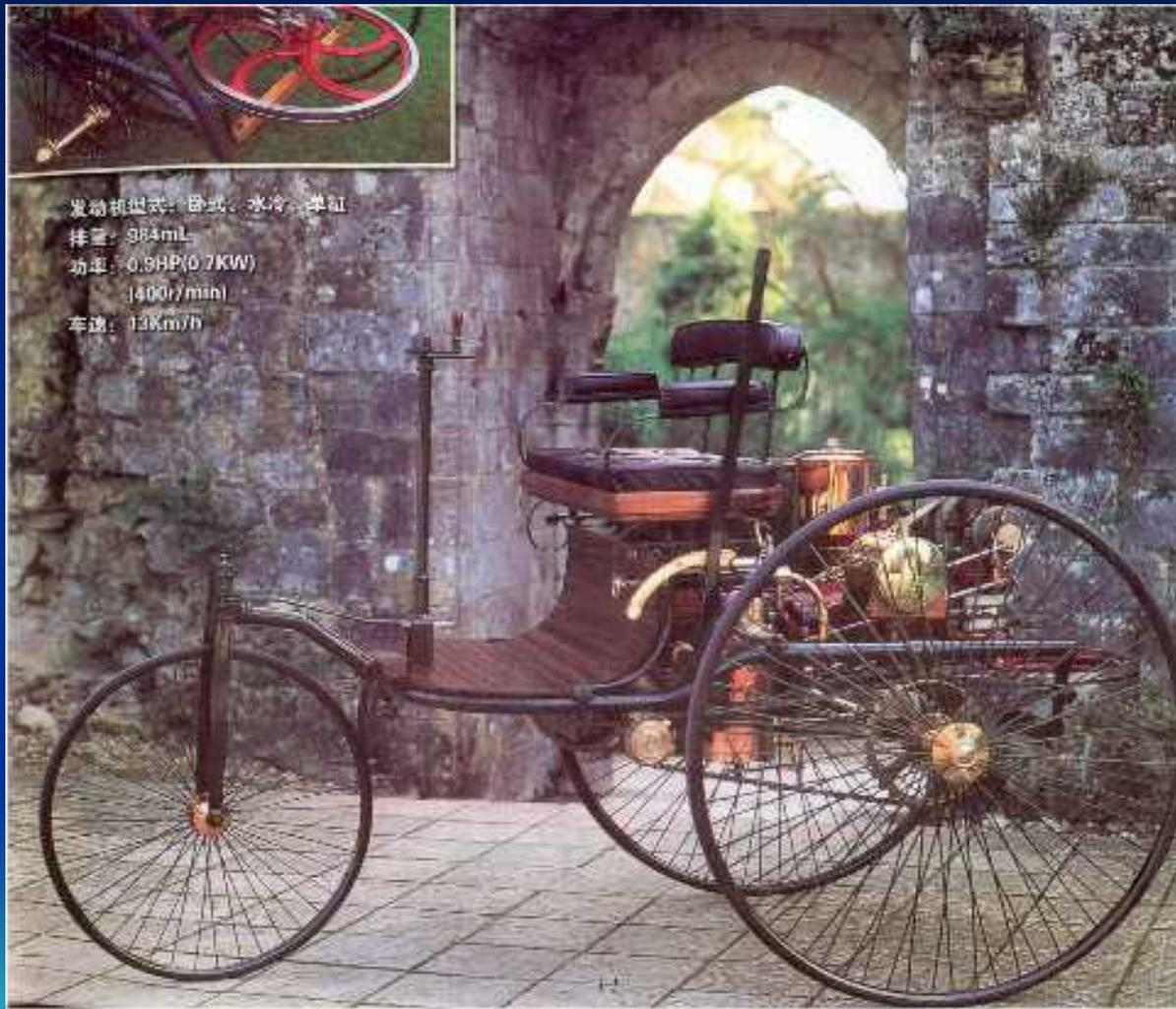
奔茨申请的专利汽车是：单缸发动机，排量为0.9 L，功率为0.65 KW，转速为400转/分，用操纵杆控制方向，有三个车轮，利用链条齿轮传动，时速为18km，全车重254kg。
