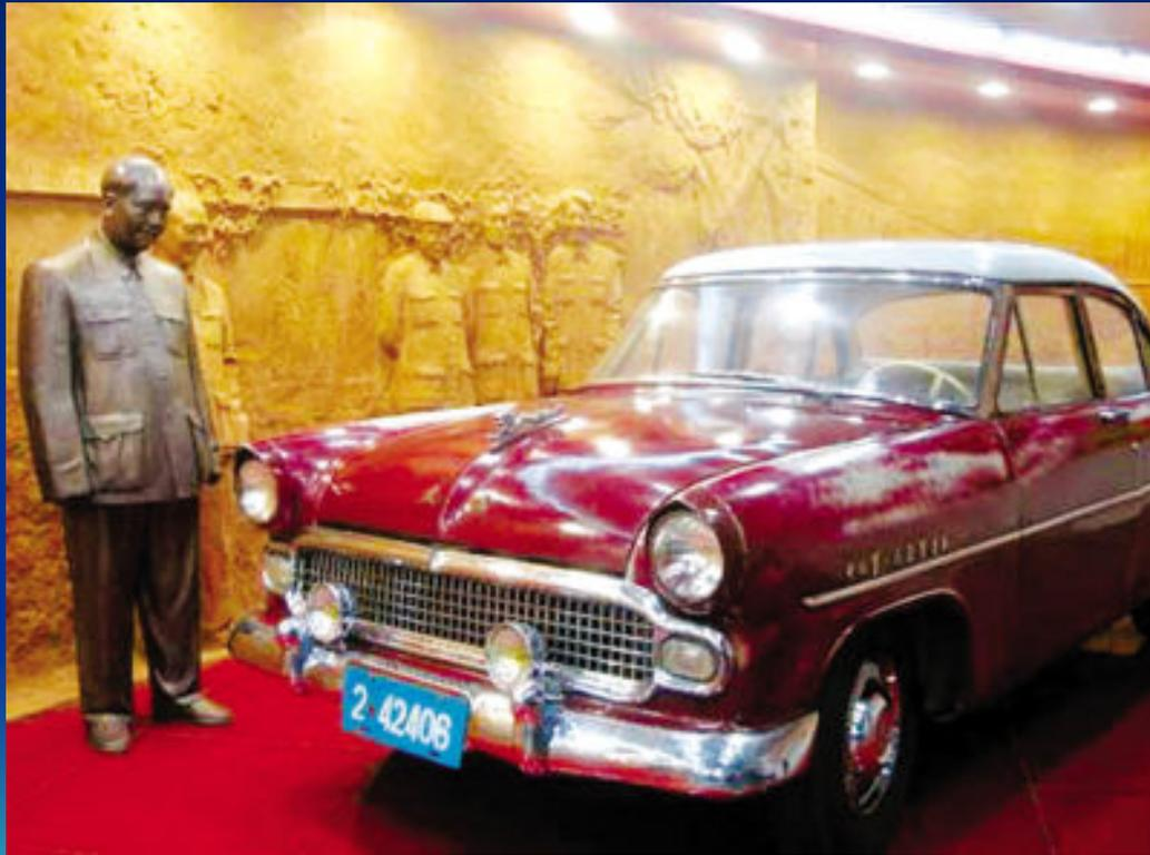
造型庄重大方，总长**5500**毫米，车头镶有一面红旗标徽，车身两侧镶嵌**5**面红旗饰标，水箱格栅为扇面形状。尾灯沿用了“东风”小轿车的宫灯造型，富有民族特色。内饰采用进口高级胡桃木装饰，高贵典雅。动力为**162**千瓦**V8**发动机，液力无级变速器。
