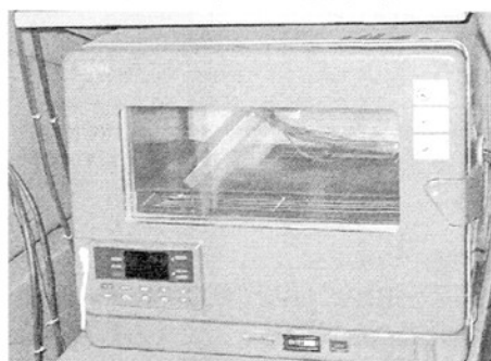
图 A.4 温控箱及实验中的电池样品
