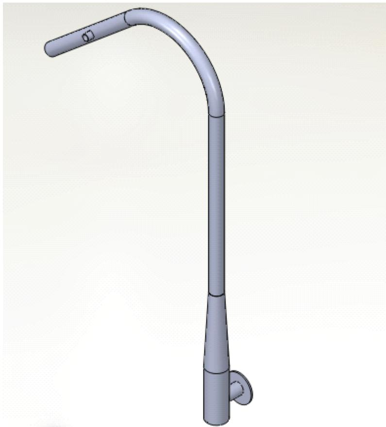
图3-12 燃烧室-喷管结构示意图
