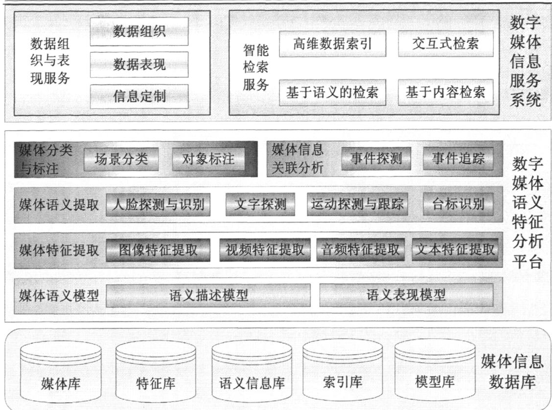
图22 支持基于内容检索的媒体特征分析平台体系结构图
