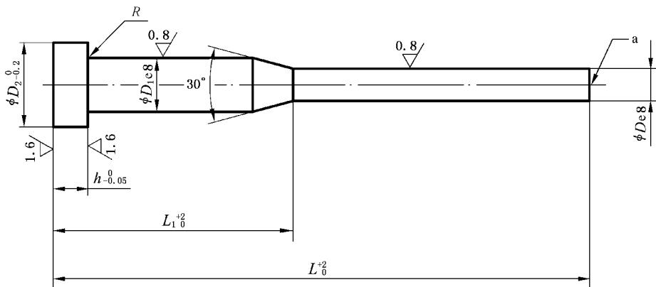
未注表面粗糙度  $R_a=6.3 \mu\text{m}$ 。
