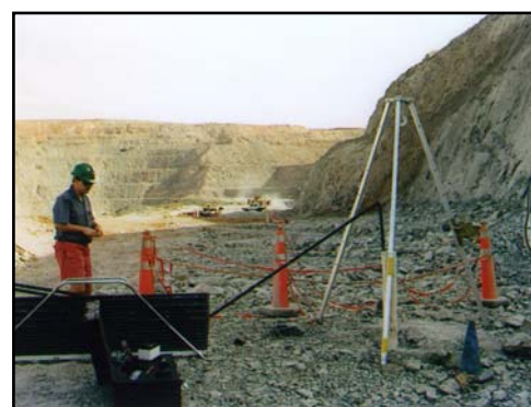
图4-3 C-ALS在测量深部空区示意图
