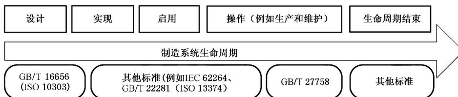
图 1 GB/T 27758 在制造系统生命周期中的概貌
