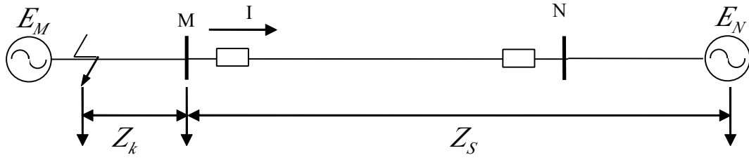
图 3.5.3 反向三相故障系统示意图
