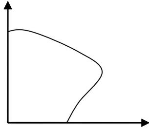
根据异步电动机的固有机械特性在  $T_{\max}$  或接近  $T_{\max}$  的情况下运行是非常不稳定的，有可能造成电动机的停转。
