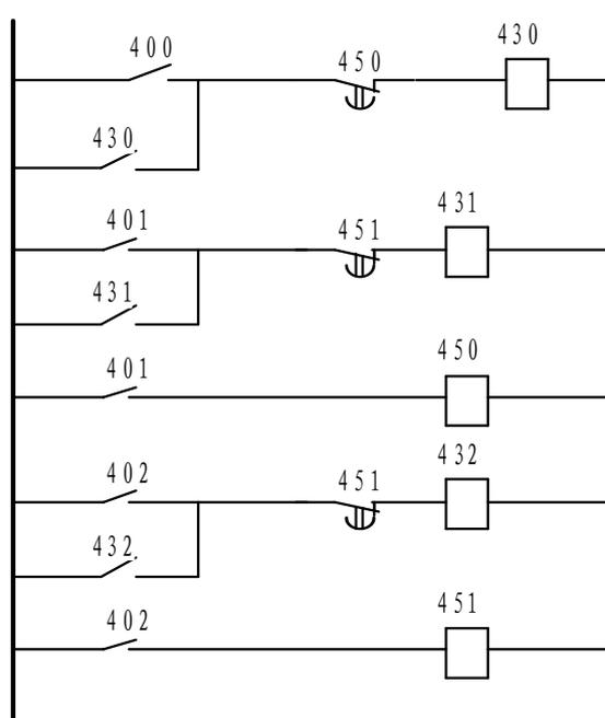
9.17 设计一条用 PLC 控制的自动装卸线。自动结构示意图如题 9.17
