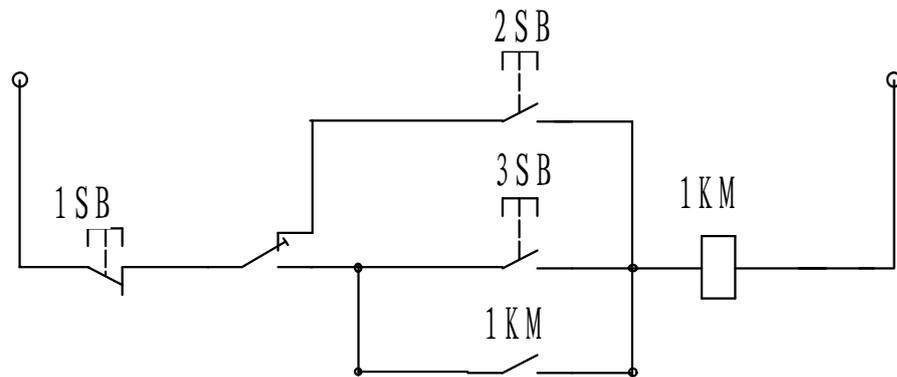
8.22 容量较大的鼠笼式异步电动机反接制动时电流较大，应在反接制动时在定子回路中串入电阻，试按转速原则设计其控制线路。
