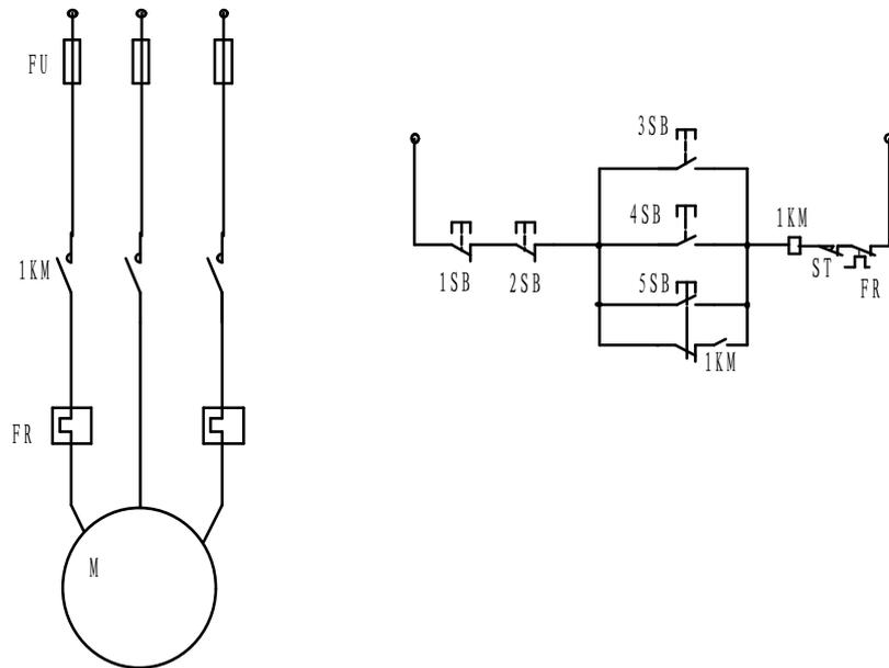
8.19 为了限制电调整时电动机的冲击电流，试设计它的电气控制线路。要求正常运行时为直接启动，而点动调整时需输入限流电阻。
