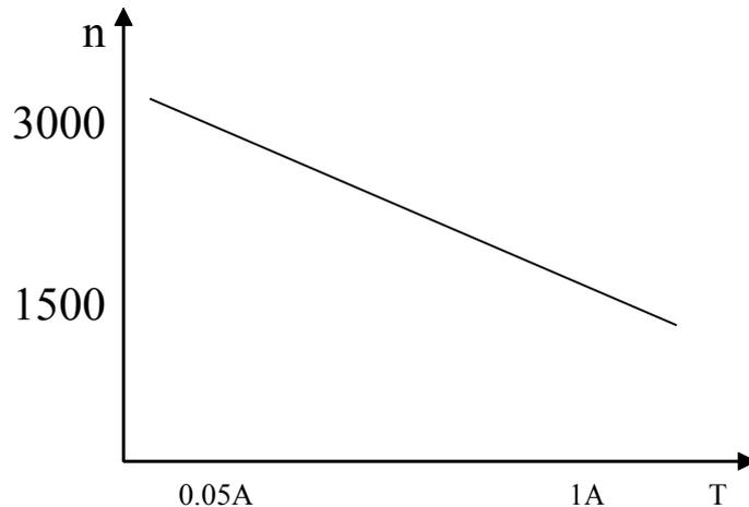
6.5 若直流伺服电动机的励磁电压一定，当电枢控制电压  $U_c=100V$  时，理想空载转速  $n_0=3000r/min$ ；当  $U_c=50V$  时， $n_0$  等于多少？
