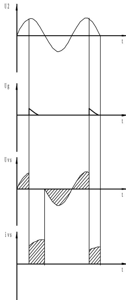
10.12 有一电阻型负载，需要直流电压  $U_d=60V$ ，电流  $I_d=30A$  供电，若采用单相半波可控整流电路，直接接在  $220V$  的交流电网上，试计算晶闸管的导通角  $\theta$ 。
