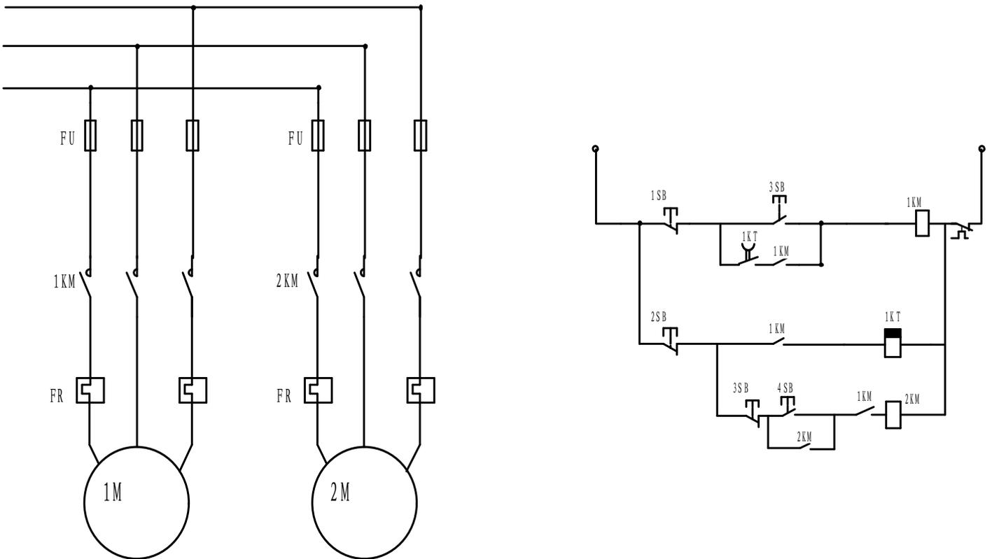
8.26 题 8.26 图为机床自动间歇润滑的控制线路图，其中接触器 KM 为润滑油泵电动机启停用接触器（主电路为画出），控制线路可使润滑有规律地间歇工作。试分析此线路的工作原理，并说明开关 S 和按钮 SB 的作用。
