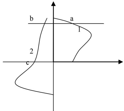
异步电动机定子相序突然改变,就改变了旋转磁场的方向,电动机状态下的机械特性曲线就由第一象限的曲线 1 变成了第三象限的曲线 2 但由于机械惯性的原因,转速不能突变,系统运行点 a 只能平移到曲线 2 的 b 点,电磁转矩由正变到负,则转子将在电磁转矩和负载转矩的共同作用下迅速减速,在从点 b 到点 c 的整个第二象限内,电磁转矩和转速 方向相反,。
