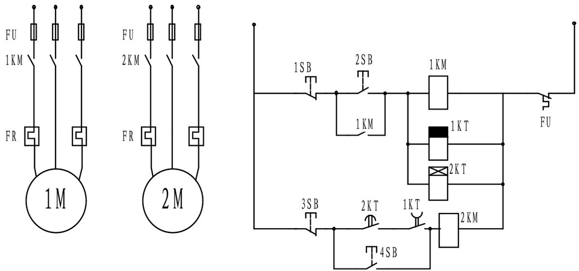
8.28 试设计某机床主轴电动机控制线路图。要求：
