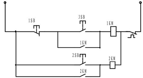
8.20 试设计一台电动机的控制线路。要求能正反转并能实现能耗制动。
