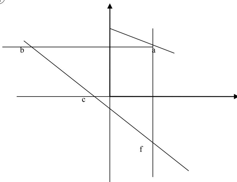
电动机正向电动状态由 a 到 b 特性曲线转变；反接制动状态转速逐渐降低,到达 c 时速度为零,反向电动状态由 c 到 f 速度逐渐增加. 稳定平衡状态,反向到达 f 稳定平衡点,转速不再变化.
