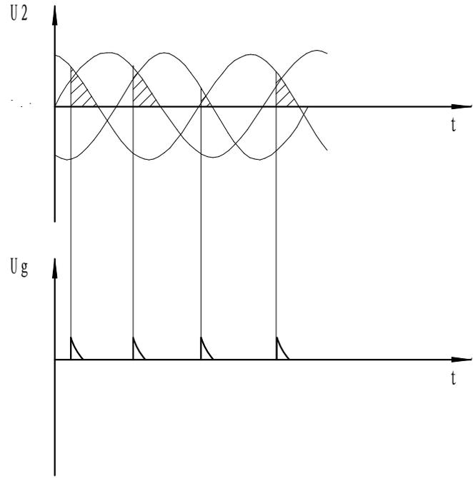
10.15 三相半波电阻负载的可控整流电路，如果由于控制系统故障，A 相的触发脉冲丢失，试画出控制角  $\alpha = 0$  时的整流电压波形。
