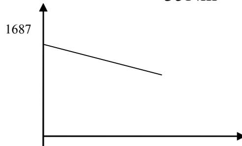
3.10 一台他励直流电动机的技术数据如下:  $P_N = 6.5 \text{ kW}$ ,  $U_N = 220 \text{ V}$ ,  $I_N = 34.4 \text{ A}$ ,  $n_N = 1500 \text{ r/min}$ ,  $R_a = 0.242 \Omega$ , 试计算出此电动机的如下特性:
