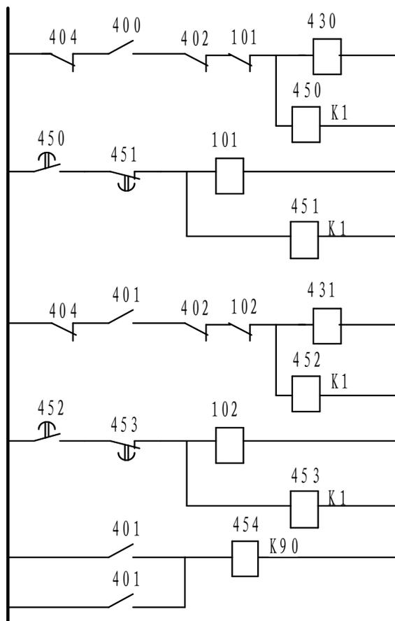
9.15 试用 PLC 设计按行程原则实现机械手的夹紧-正转-放松-反转-回原位的控制。
