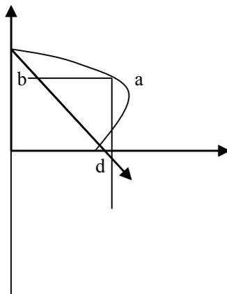
能耗制动 首先将三项交流电源断开,接着立即将一个低压直流电圆通入定子绕组.直流通通过定子绕组后,在电动机内部建立了一个固定的磁场,由于旋转的转子导体内就产生感应电势和电流,该
