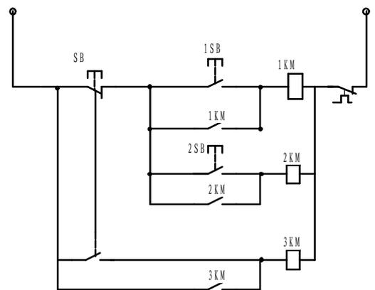
8.21 冲压机床的冲头，有时用按钮控制，又实用脚踏开关操作，试设计用转换开关选择工作方式的控制线路。
