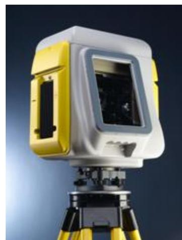
本次点云配准数据的获取就是通过 Trimble GX 三维激光扫描仪对乒乓球进行扫描后得到的，下面是经过拟合后的精确的乒乓球球心坐标：
