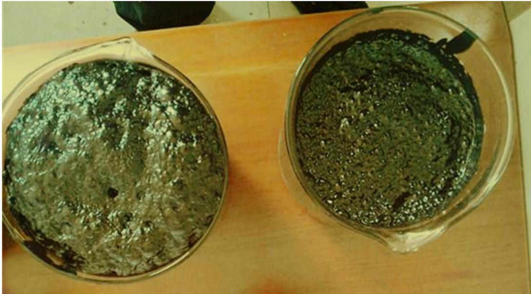
图 3.20 加入过氧化氢后污泥中产生大量气泡导致污泥膨胀
