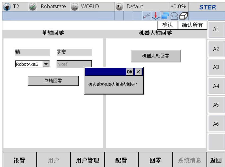
图 3.18 机器人轴回零确认
