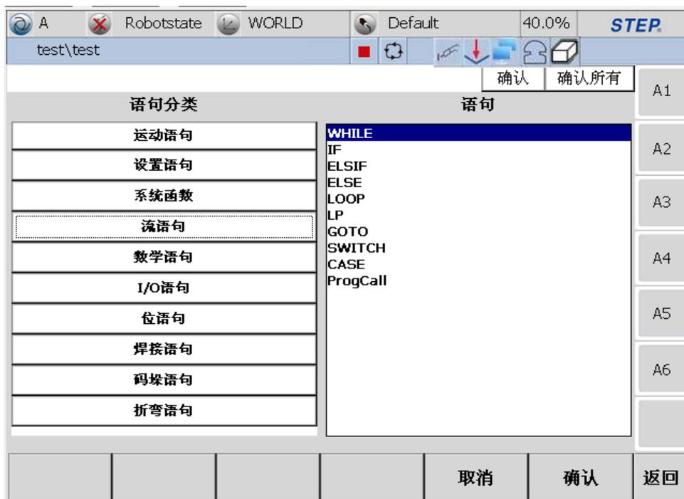
图 5.11 机器人流程控制语句选择界面
