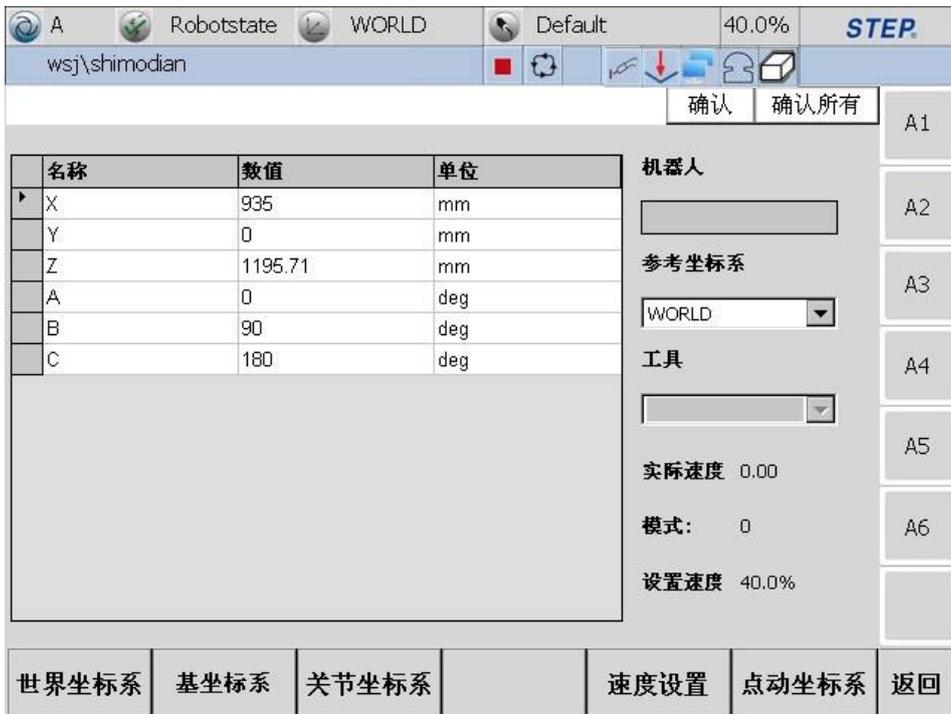
图 3.101 机器人笛卡尔位置界面示意图
