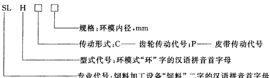
示例:SLHP320 表示环模内径为 320 mm、皮带传动的压制机。
