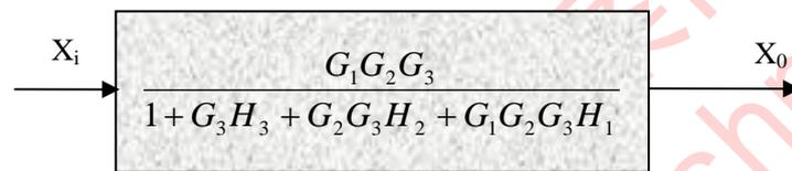
$$\phi(s) = \frac{G_1 G_2 G_3}{1 + G_3 H_3 + G_2 G_3 H_2 + G_1 G_2 G_3 H_1}$$
