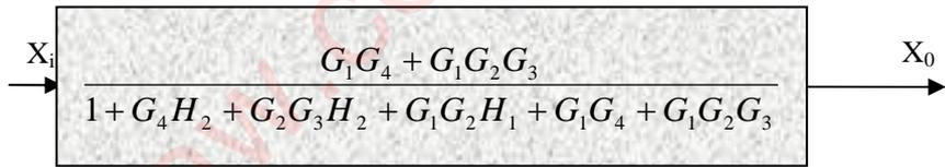
$$\phi(s) = \frac{G_1 G_4 + G_1 G_2 G_3}{1 + G_4 H_2 + G_2 G_3 H_2 + G_1 G_2 H_1 + G_1 G_4 + G_1 G_2 G_3}$$
