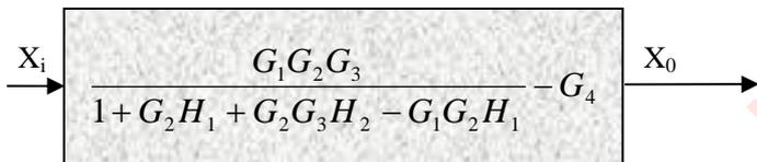
$$\phi(s) = \frac{G_1 G_2 G_3}{1 + G_2 H_1 + G_2 G_3 H_2 - G_1 G_2 H_1} - G_4$$
