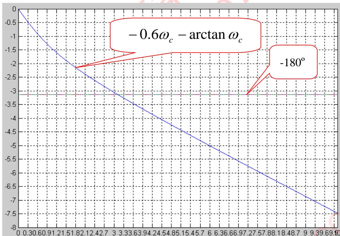
5-13. 已知闭环系统的开环传递函数为  $G(s) = \frac{Ke^{-0.8s}}{s(s+1)}$ , 试确定系统稳定的
