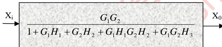
$$\phi(s) = \frac{G_1 G_2}{1 + G_1 H_1 + G_2 H_2 + G_1 H_1 G_2 H_2 + G_1 G_2 H_3}$$
