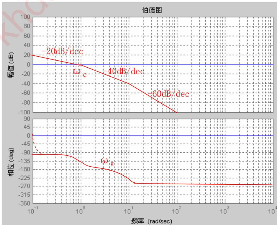
开环右极点数目 $P_R=0$ , 如图伯德图作辅助线, 可见在幅值穿越频率前, 没有发生相位穿越, 故 $N=0$ , 闭环系统无右极点, 系统稳定。
